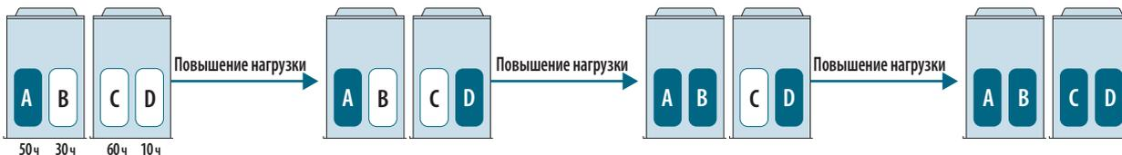
Пример: Выравнивание рабочих циклов компрессоров
