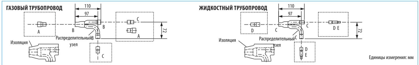
**РАЗМЕРЫ ТОЧЕК СОЕДИНЕНИЯ КАЖДОЙ ДЕТАЛИ (ПОКАЗАНЫ ВНУТРЕННИЕ ДИАМЕТРЫ ТРУБ)**
